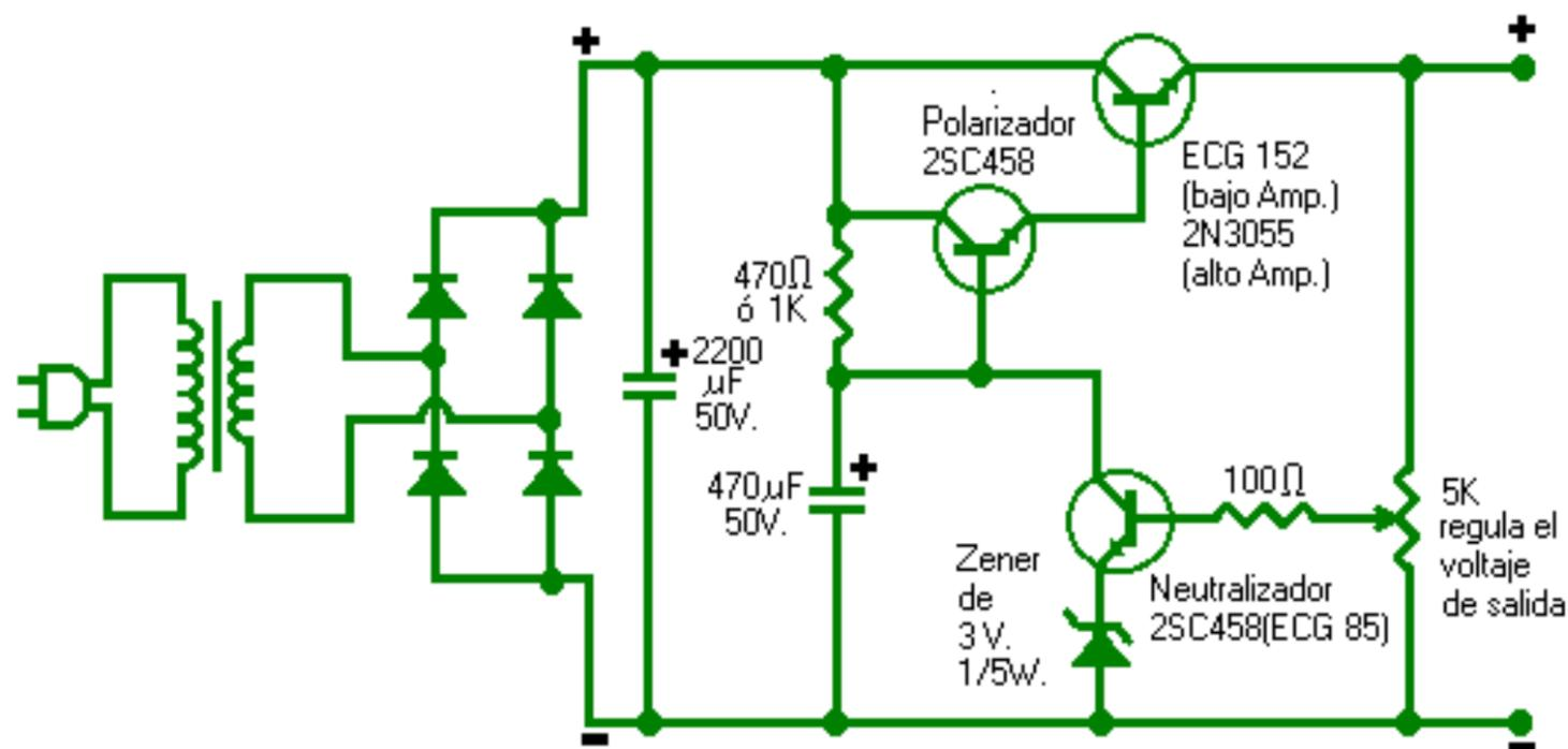
El transformador para esta fuente puede ser de 12, 15 ó 25 voltios de 1 á 5 amperios, en la configuración actual es para 2 amperios, si deseas ampliar el amperaje debes substituir Q1 por el 2N3055 y el Q2 por el ECG 152. la función del zener es mantener en 3 voltios el nivel más bajo y que no se dañen los transistores.
